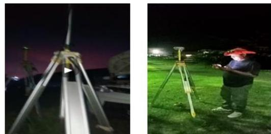
Gambar 1. Pemasangan bes di titik BM BPN dan Pemasangan roper di BM baru
