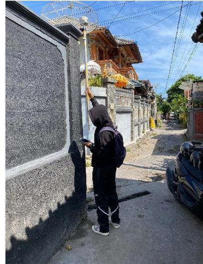
Gambar 3 Pengukuran Batas-Batas
