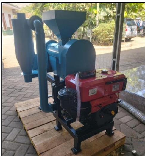
Gambar 4. Mesin Huller
