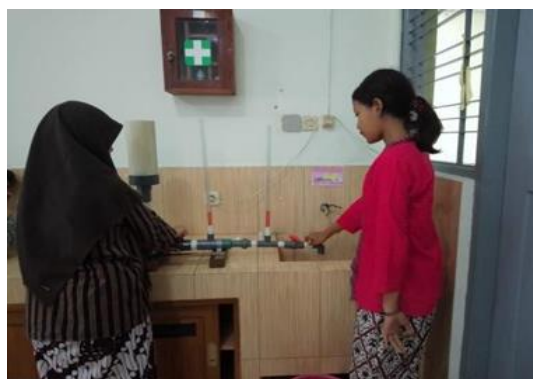
Gambar 4. Kegiatan Percobaan Menggunakan Venturimeter
