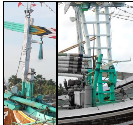
Gambar 3. Cangga Layar dan Tiang Panggungan (Dokumentasi : Ida Bagus Made Pandit Parastu)
