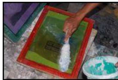
Gambar 15. Pengolesan kaporit atau soda api, Sumber : I Gst Md Prawira Yudha
