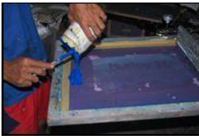
Gambar 12. Menuangkan cat sablon ke screen , Sumber : I Gst Md Prawira Yudha
