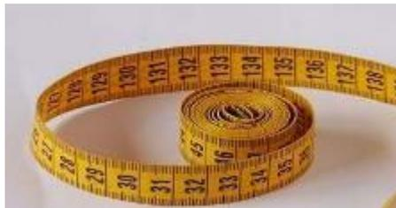
Pita ukur sering disebut juga dengan meteran yang berbentuk pita. Pita ukur merupakan alat penunjang dalam pembuatan kerajinan makrame. Umumnya pita ukur digunakan untuk mengukur panjang atau tinggi suatu benda. Dalam pembuatan kerajinan makrame pita ukur berukuran 150cm atau 60inch berfungsi mengukur panjang pendeknya tali makrame sesuai kebutuhan. Penggunaan pita ukur dibanding penggaris lebih mudah karena pita ukur lebih fleksibel yang dapat ditekuk dibanding penggaris yang kaku.
