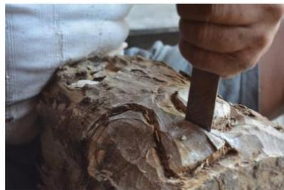
Kayu pule yang sudah dipotong akan diberi pola untuk diukir. Pengukiran ini dilakukan untuk membuat bentuk wajah secara global agar bagian lainnya mudah untuk diukir diantaranya bagian mata, hidung, dan giginya. Selanjutnya akan dilakukan proses pengamplasan agar sisa-sisa dari proses pemahatan menjadi lebih rapi dan bisa lanjut ke pengecatan.
