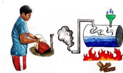
Proses pemasakan ini memasukkan bubur kedelai ke dalam kubangan pemasakan yang telah disiapkan, kubangan tersebut terbung dengan pipa jirigen (tong penggodokan) yang telah dilakukan proses pembakaran sehingga mengeluarkan uap panas yang mengakibatkan bubur kedelai menjadi masak. Dalam proses ini dibutuhkan waktu selama 20-30menit juga tergantung api yang digunakan. Suhu pada pemasakan ini diperkirakan mencapai 200<sup>0</sup>
