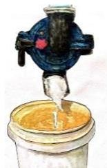
Penggilingan merupakan proses selanjutnya setelah penakaran masing-masing kedelai. Pada proses ini pengrajin menggunakan mesin penggiling dynamo dengan tenaga listrik, kedelai di giling dan di alirkan sedikit air agar kedelai yang keluar tidak begitu keras hingga menjadi bubur kedelai.
