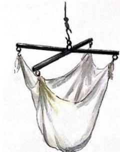
Pentang penyaringan terbuat dari besi yang sudah di las mempunyai bentuk menyilang dan terdapat lingkaran besi pada bagian ujung tempat mengikatkan kain sifon, memiliki ukuran 64cm x 64cm. Alat ini digunakan untuk menyaring bubur kedelai yang telah dimasak.
