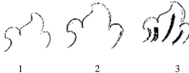
Setelah pola daun dibentuk menggunakan mesin router atau profil, daun dipahat menggunakan pahat penguku ukuran 2 – 3 cm dengan arah pahat dalam kebawah.
