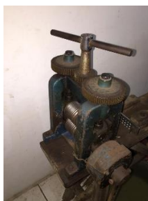
Gambar Roll Giling (Penglindesan) Oleh (I Made Suarpradana K)
