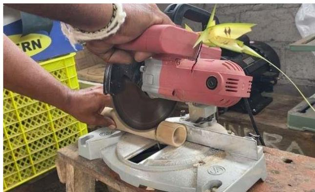
Gambar 2. Proses Pemotongan Bambu
