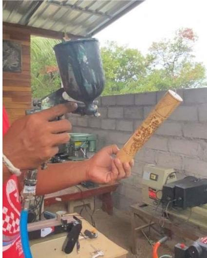
Gambar 11. Proses Pengecatan *Finishing* Kerajinan Bambu
