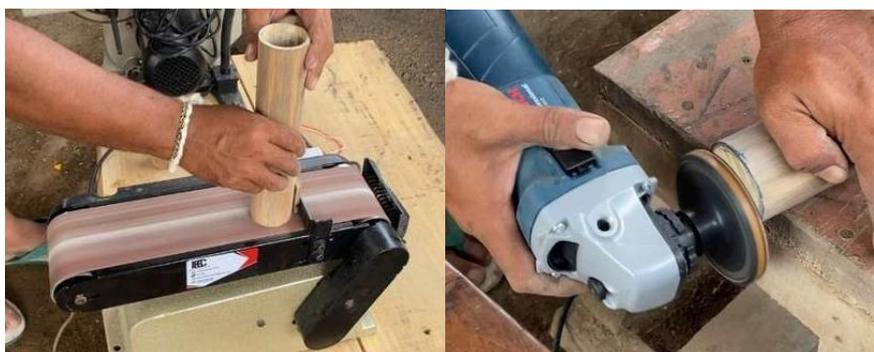
Gambar 5. Proses Pengamplasan Kerajinan Bambu
