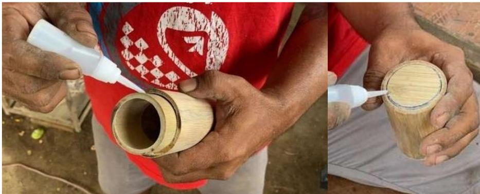
Gambar 4. Proses Pengeleman Bambu
