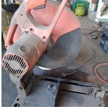
Gambar 11. Alat Pemotong Besi
