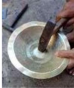
Gambar 13. Proses Menghaluskan Logam
