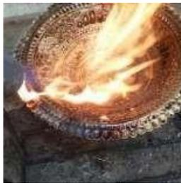
Gambar 20. Proses Pembakaran Untuk Membersihkan Logam Dari Jabung
