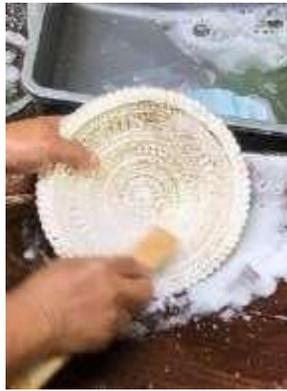
Gambar 22. Proses Penggosokan Logam Dengan Alat Siikat Besi
