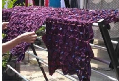
Gambar 7. Penjemuran kain usai proses pencelupan dari larutan warna *Remasol*
