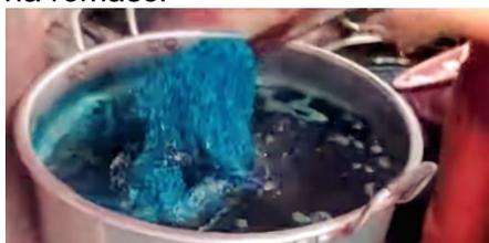
Gambar 6. Pencelupan kain ke larutan warna *Remasol*
