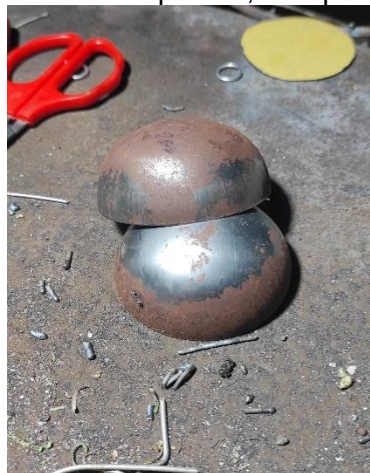
Gambar 5. Proses Pembentukan pada Plat Besi (Foto: Dokumen pribadi, 11 April 2024)
