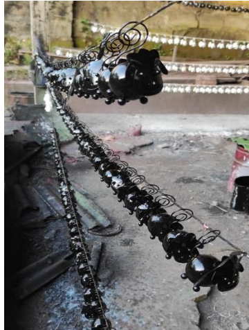
Gambar 8. Proses Pengecatan Dasar (Foto: Dokumen pribadi, 23 April 2024)
