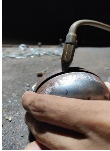
Gambar 6. Proses Pengelasan pada Plat Besi (Foto: Dokumen pribadi, 11 April 2024)
