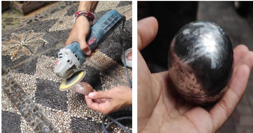
Gambar 7. Proses Pengasahan (Foto: Dokumen pribadi, 11 April 2024)
