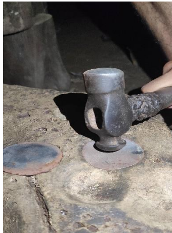
Gambar 4. Proses Pembentukan pada Plat Besi (Foto: Dokumen pribadi, 11 April 2024)
