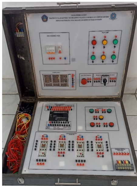
Gambar 2. Media Pembelajaran Trainer Instalasi Kontrol Motor Listrik Tiga Fasa Star Delta Dan Forward Reverse Dengan Kontrol PLC
