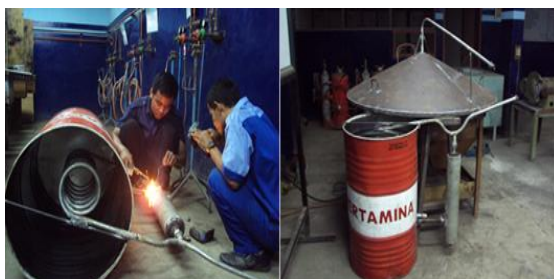
Gambar 3. Pembuatan alat destilasi di Lab SMK 3 Singaraja
