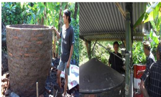
Gambar 4. Pembuatan tungku pirolisis
