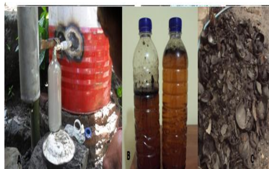
Gambar 6. Hasil tungku pirolisis (A) proses pendinginan, (B) Liquid smoke (asap cair) hasil pelatihan, (C) Arang hasil samping dari produksi asap cair
