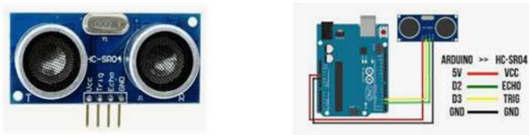
Gambar 9 . Sensor Ultrasonik HC-SR04 dan Koneksi ke Arduino
