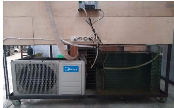
Gambar 2. Media Pendingin Kombinasi Udara dan Air disisi Kondensor
