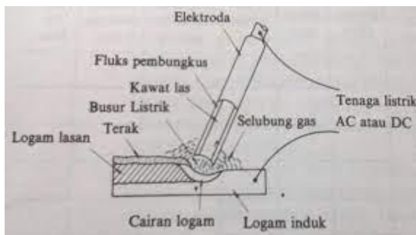
Gambar 2 Pelelehan Elektroda (Sumber: www.sinta.unud.ac.id )
