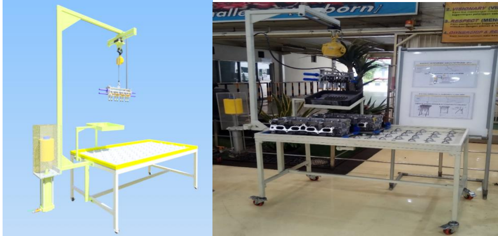
Gambar 12. Foto alat bantu Assembly lash adjuster hasil dari perancangan
