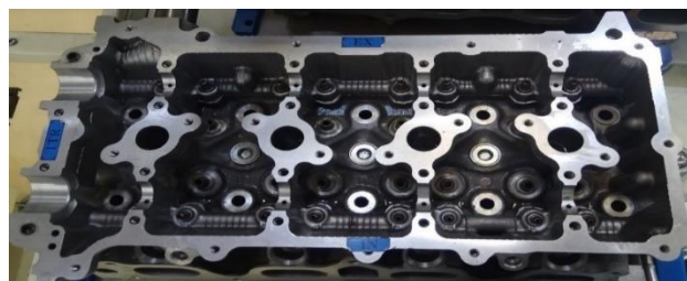
Gambar 3. Cylinder Head sebagai tempat lash adjuster
