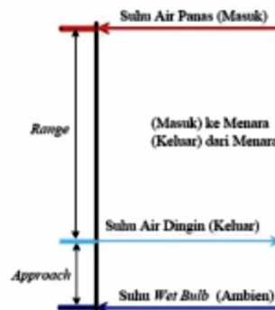
Gambar 2. Range dan Approach Temperatur pada Cooling Tower ( Faizah, 2020)
