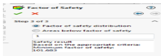
Gambar 8 Factor Of Safety Swing Arm Modifikasi 1 Tanpa Beban Pengendara
