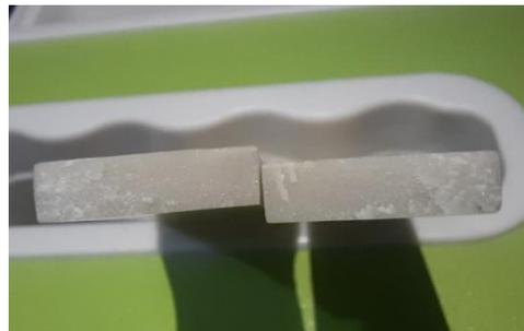
Gambar 4. Foto patahan spesimen komposit fraksi volume serat 0%.
