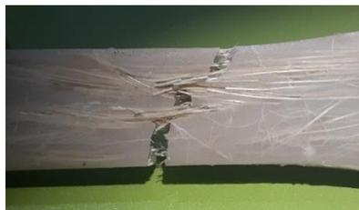
Gambar 13. Foto patahan spesimen komposit fraksi volume serat 15%.
