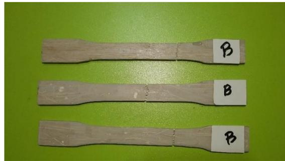
Gambar 6. Spesimen komposit fraksi volume serat 5% setelah dilakukan pengujian tarik.
