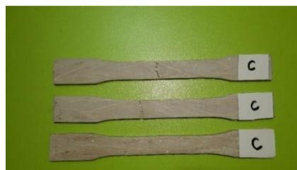
Gambar 9. Spesimen komposit fraksi volume serat 10% setelah dilakukan pengujian tarik.
