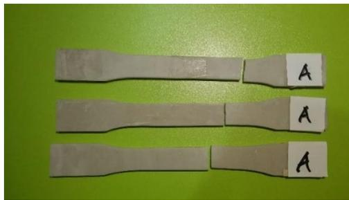
Gambar 3. Spesimen komposit fraksi volume serat 0% setelah dilakukan pengujian tarik.
