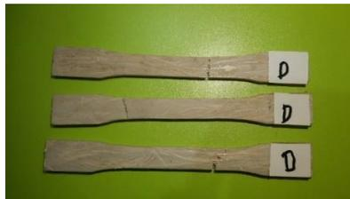
Gambar 12. Spesimen komposit fraksi volume serat 15% setelah dilakukan pengujian tarik.
