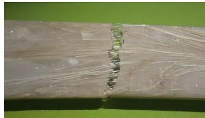
Gambar 10. Foto patahan spesimen komposit fraksi volume serat 10%.
