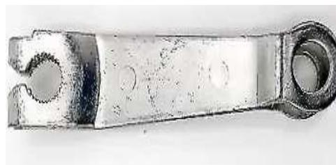
Gambar 19. Cacat yang terjadi pada *arm rear brake*
