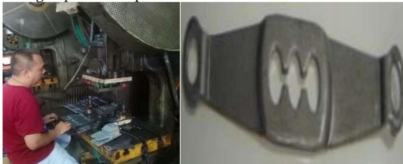
Gambar 5. Proses *piercing* dan bentuk material pada proses *piercing*
