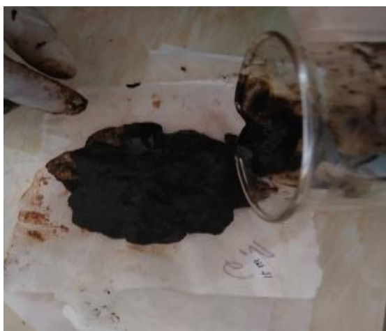
Gambar 1. Hasil sintesis nanopartikel melalui metode kopresipitasi
