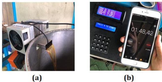
Gambar 6. Pengujian Sistem Pendingin, b) Pengukuran Suhu Dan Waktu
