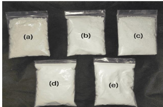
Gambar 5. Pengaruh Peningkatan Produk PCC Terhadap Warna Powder : (a) Bahan Baku, (b) 15 menit, (c) 30 Menit, (d) 45 Menit, dan (e) 60 Menit
