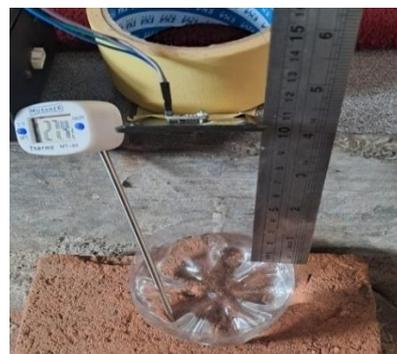
**Gambar 8.** Konfigurasi Pengujian Akurasi Sensor
