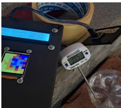
**Gambar 7.** Pengujian Akurasi Sensor
