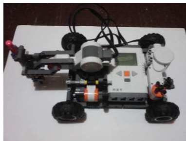
Gambar 4.5 Implementasi Mekanik Perangkat Keras Robot Penulis Karakter
