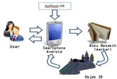
Gambar 2. Blok Diagram Proses interaksi aplikasi dengan user
