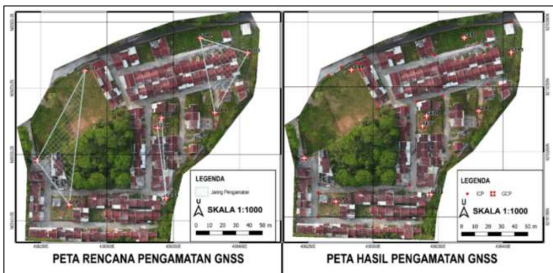
Gambar 1. Hasil pengolahan foto udara dari hasil orthorektifikasi dari data koordinat pengolahan GNSS
